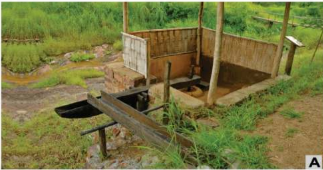
A,B- जल संचालित तुई-चांगसु की कार्य प्रणाली का जीवंत प्रदर्शन |/Live demonstration of water operated Tui-Changshu.
